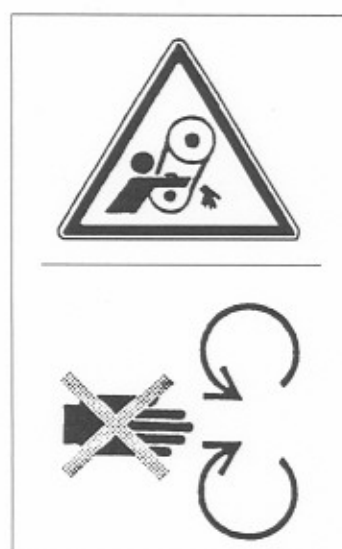
图 C.3 机器工作时,不得打开或拆下安全防护装置
