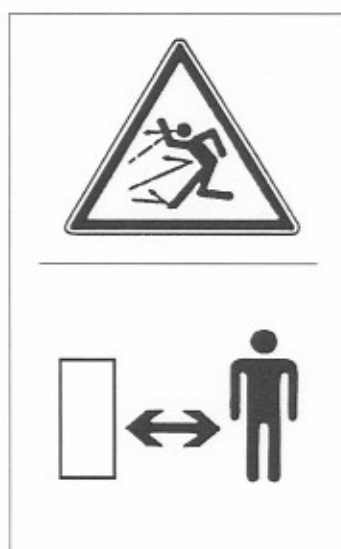
图 C.2 机器工作时,排料口及切刀旋转方向严禁站人
