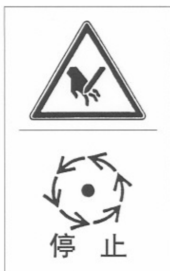
图 C.1 机器运转时,严禁人触及切刀或输送辊
